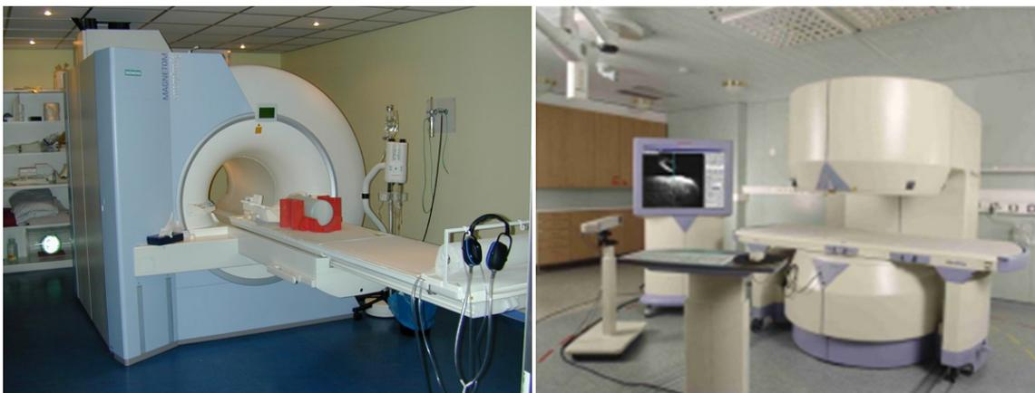
**Figure III.1 : Systèmes dédiés à l'IRM à géométrie fermée et ouverte**
