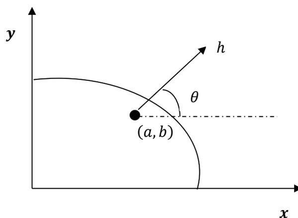
**Figure 2.4.1 :** Détermination de l'altitude le long d'un nouvel axe
