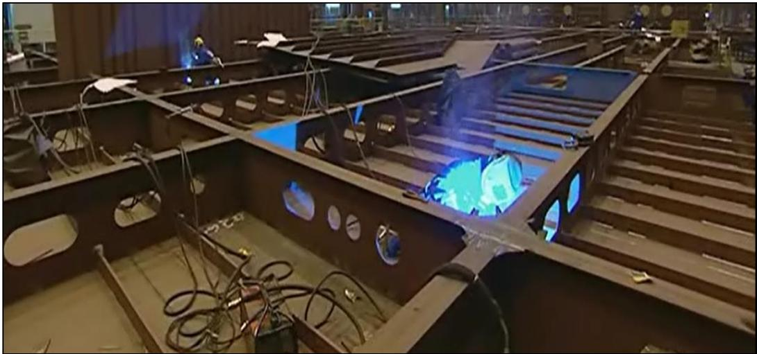
Figure II.27. Assemblage les éléments constituant la charpente de fond.
