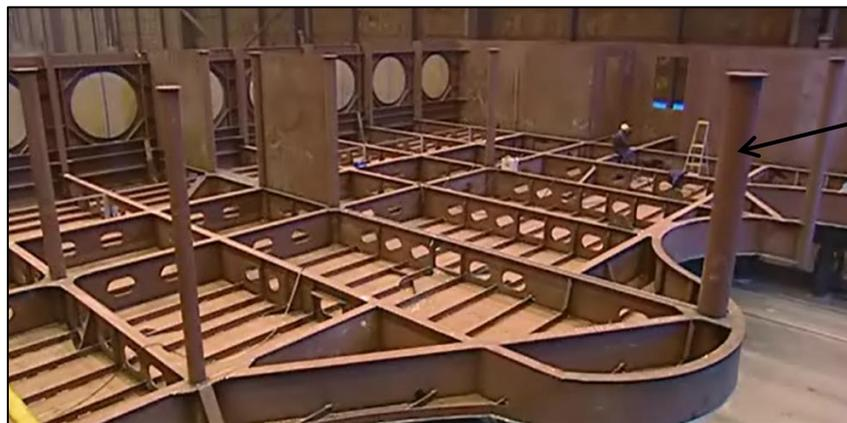
Figure V. 1. L'emplacement des épontilles dans la charpente de fond du navire.
