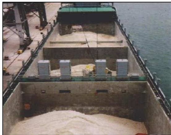
Figure III.3. Ecoutilles du navire commercial.
