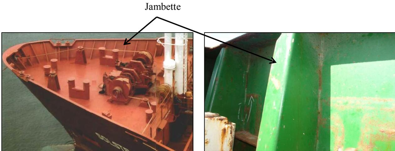
Figure VII.4. Fixation du pavois par des jambettes.
