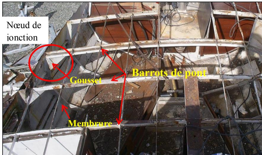
Figure III.10. Jonction Barrot-Membrure à l'aide de gousset.
