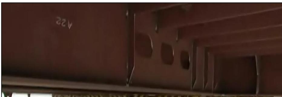
Figure II.7. Varangue évidée intercalé avec une varangue étanche renforcé par des raidisseurs.
