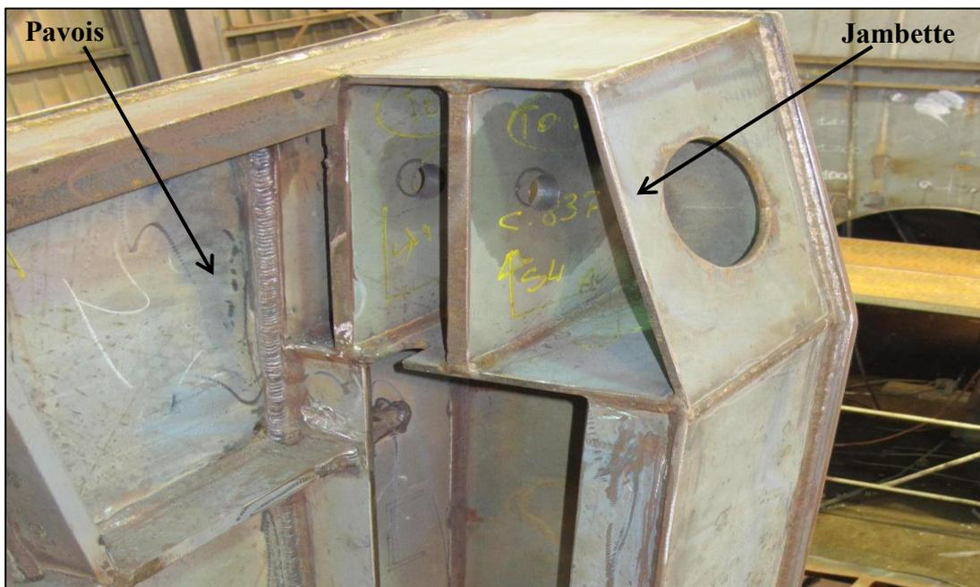
Figure VII.5. Soudage du pavois et les jambettes de fixation (goussets).
