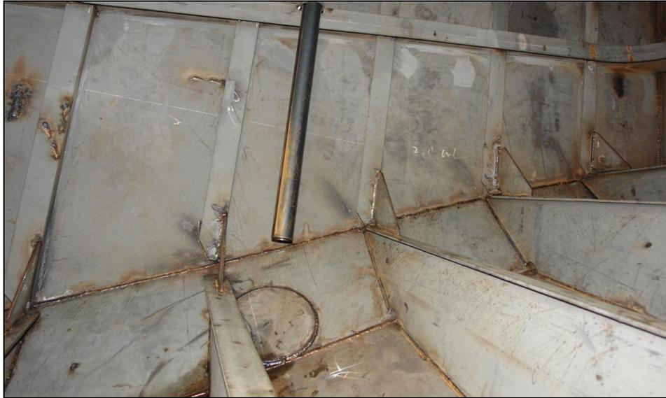
Figure IV.18. Détail des jonctions des membrures avec les varangues à l'extrémité du bordé de la muraille.
