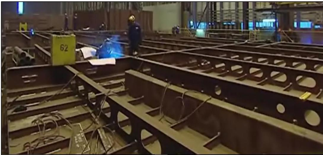
Figure II.28. Charpente de fond dans un système de raidissage longitudinal.
