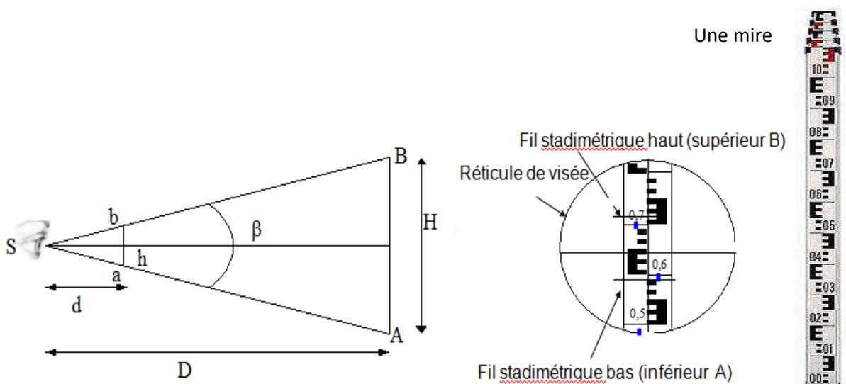
Figure II. 23. Principe de mesure par stadimétrie.
