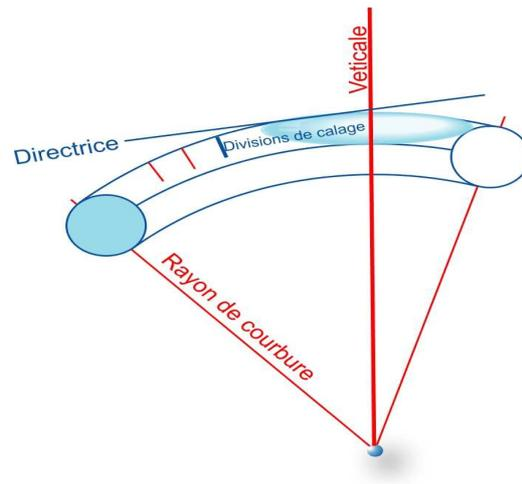
Figure III. 10. Nivelle torique.
