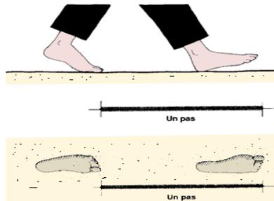
Figure II. 3. Mesure par comptage de pas.
