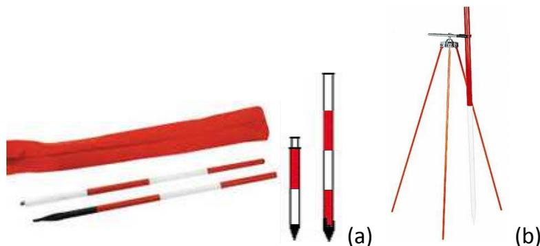
Figure II. 10. Jalons d'alignement (a) et porte jalon (b).
