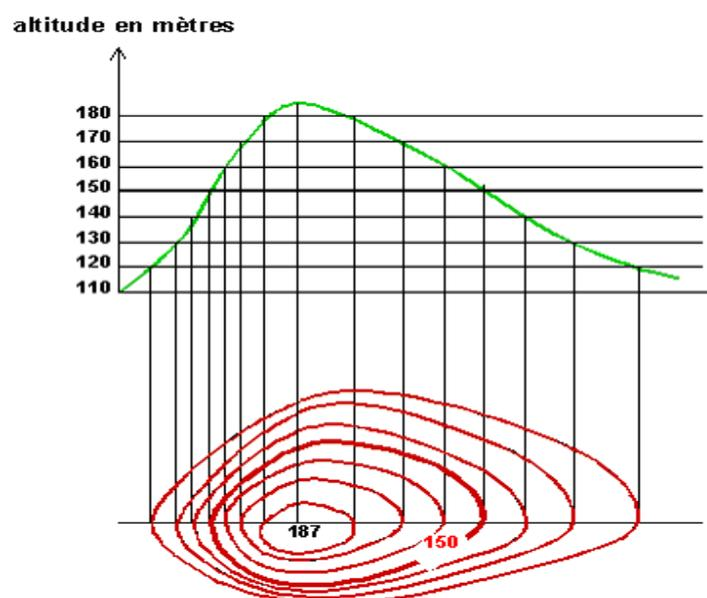
Figure I. 6. Principe de détermination des courbes de niveau.
