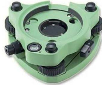
Figure III. 13. Socle à 3 Vis calantes (Embase).
