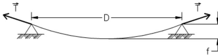
Figure II. 22. Effet de chaînette sur une mesure en mode suspendu
