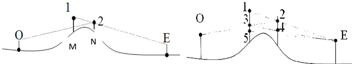
Figure II. 13. Alignement de droite avec obstacle franchissable.
