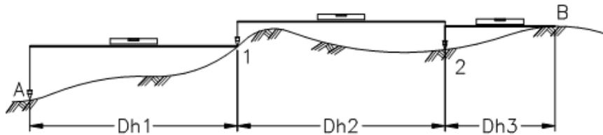
Figure II. 18. Mesure au ruban par ressauts horizontaux.
