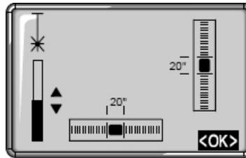
Figure III. 9. Nivelles électroniques.
