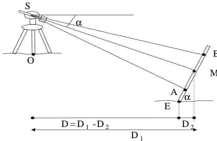
Figure II. 27. Mire perpendiculaire à la visée principale (Visée descendante).
