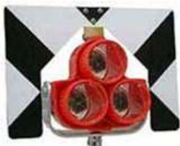
Figure II. 37. Prismes pour télémètre.
