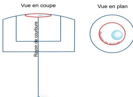
Figure III. 7. Nivelles sphérique.
