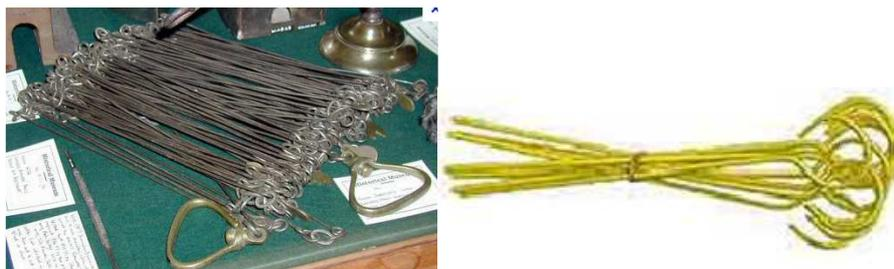
Figure II. 5. Chaîne d'arpenteur.
