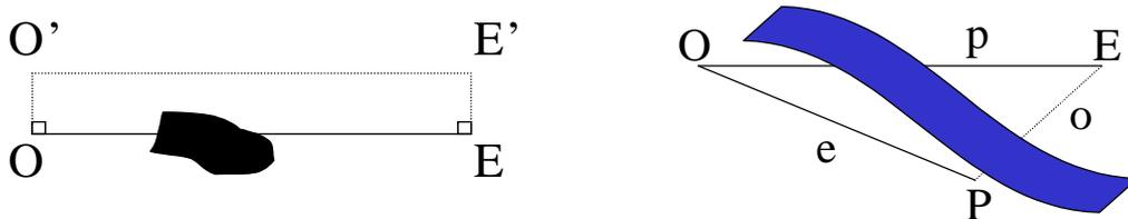
Figure II. 14. Alignement de droite avec obstacle infranchissable mais visibilité.
