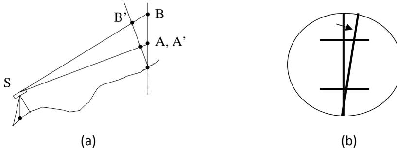
Figure II. 29. Défaut de verticalité (a) - Inclinaison latérale (b).
