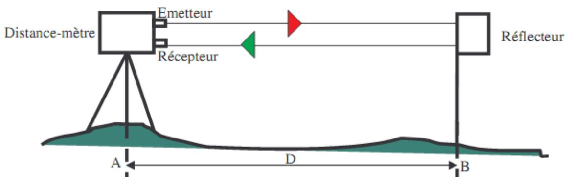
Figure II. 35. Un IMEL avec émetteur et récepteur.
