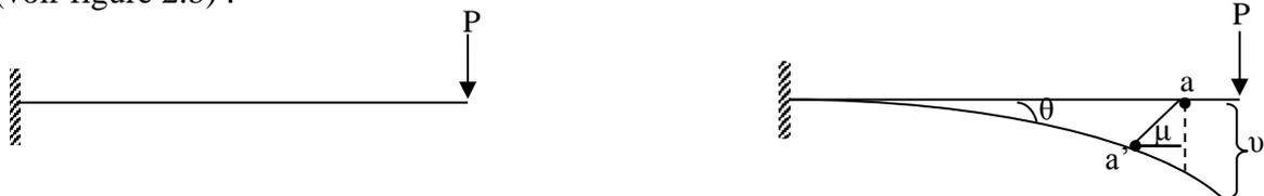
**Fig.2.a** Etat initial (avant déformation)**fig.2.b** Etat final (après déformation)**Figure V.2.** Etat de déformation
