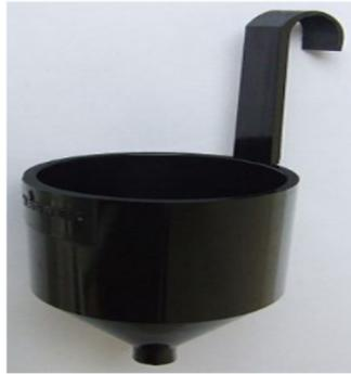
**Figure I. 17 :** Coupe normalisée pour déterminer le temps de vidange
