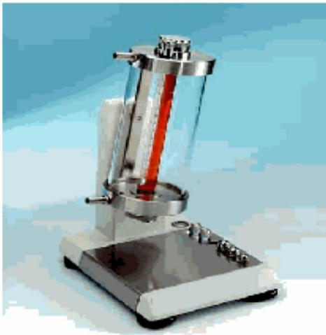
En fait la mesure de  $v_{lm}$  serait assez imprécise si on n'opérait pas dans un tube assez étroit à cause des effets de tangage de la bille autour de sa trajectoire théorique verticale. Mais de ce fait on a des effets de parois qui modifient sensiblement le calcul. De plus, on opère souvent avec le tube incliné.
