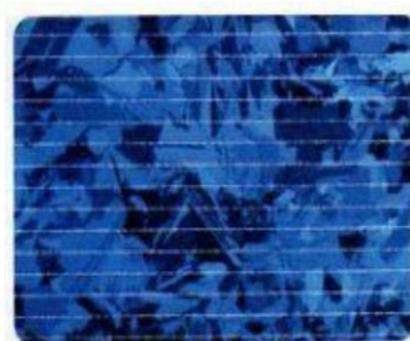
Figure (10): Cellule en silicium polycristallin.
