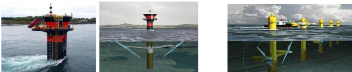
Figure (3) : Photos d'hydroliennes à axe horizontal
