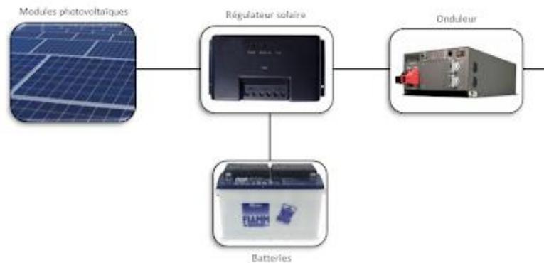
Figure (4) : Exemple d'une installation solaire PV
