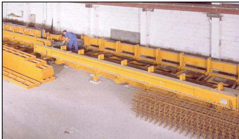
Figure 45 : Coffrage métallique pour poutres
