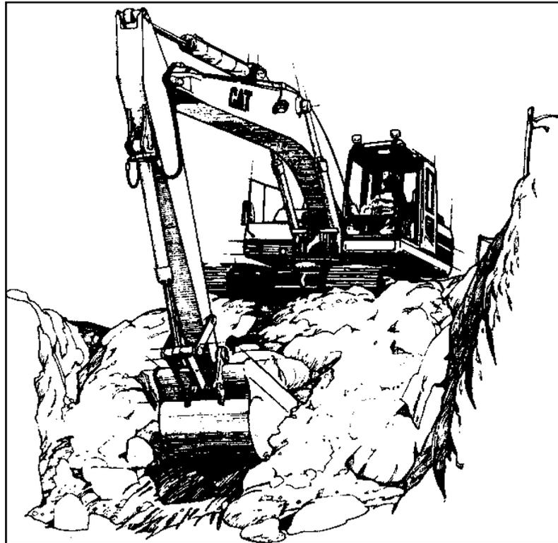
Figure 20 : Pelle hydraulique en rétrocaveuse
