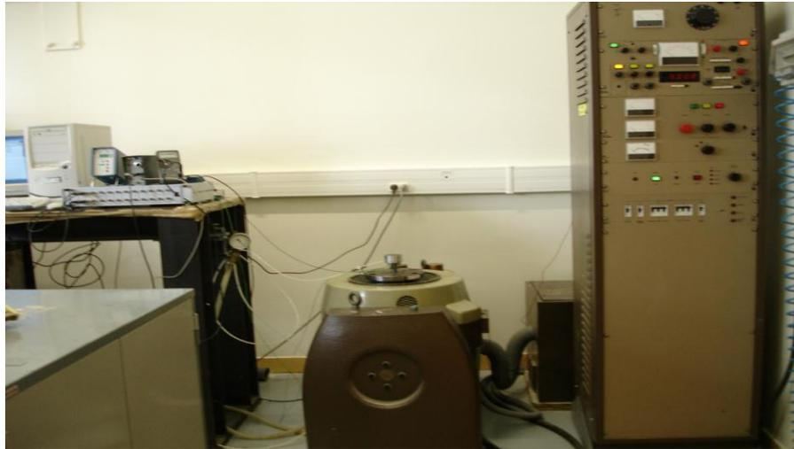
**Figure III.8:** Le pot vibrant relié à l'armoire de commande
