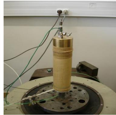
**Figure III.11:** L'échantillon placé sur le pot vibrant
