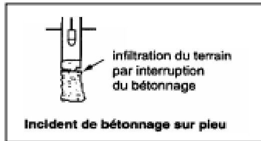
Figure 3.27 : Désordre du à une mauvaise exécution
