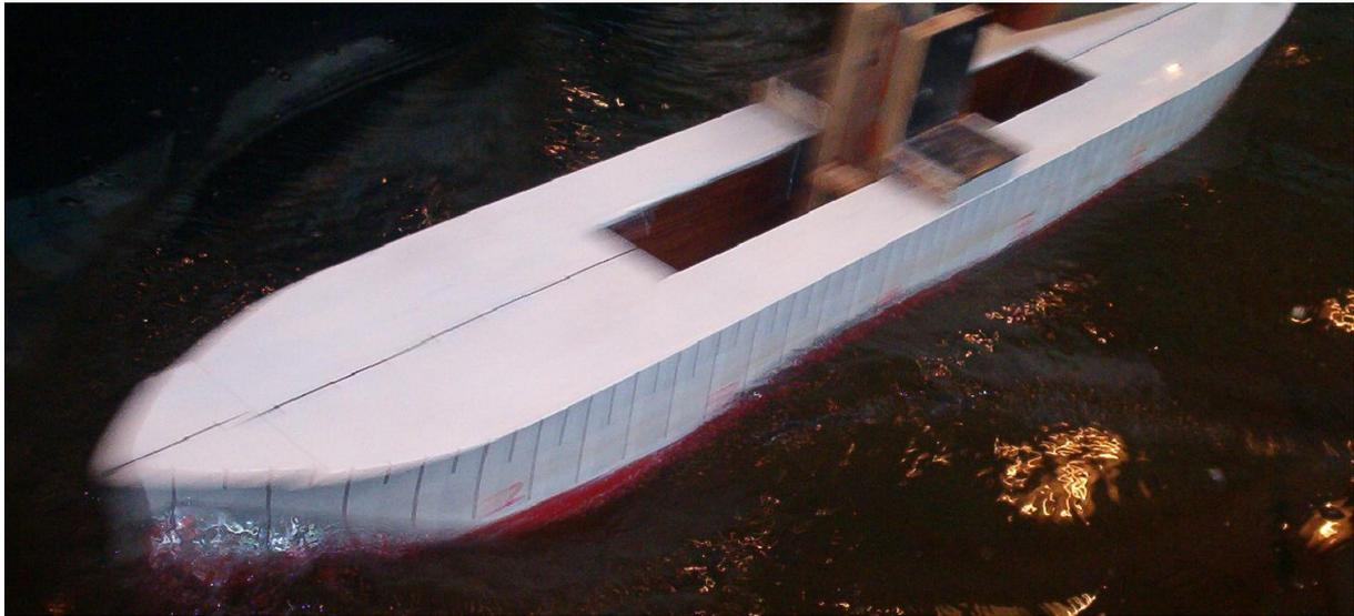
Figure 3.2 Vérification de la stabilité de la maquette
