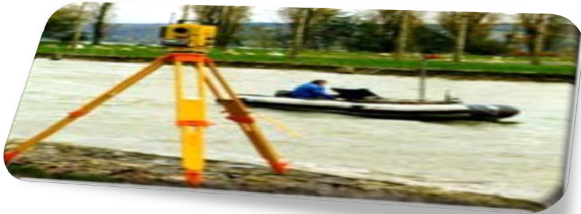
Photo (I.1): Estimation de l'envasement par la méthode de nivellement (Tachéomètre)
