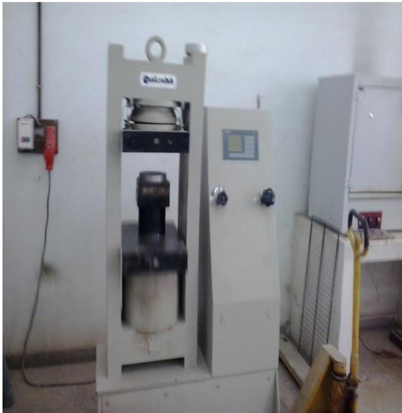
**Figure 2.3** Presse de capacité 3000 KN.
