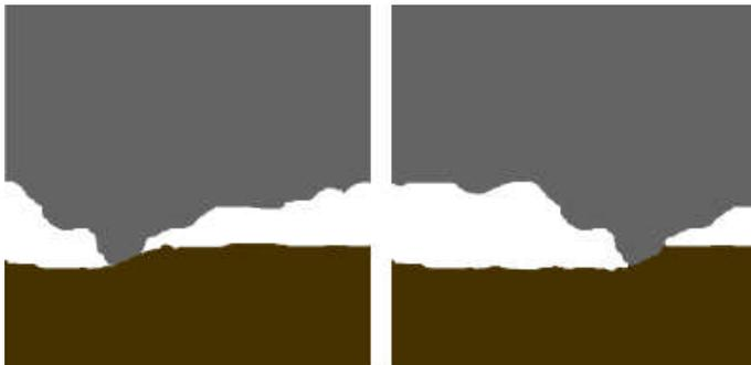
Figure 2.3 : Mécanisme d'usure abrasive [65].
