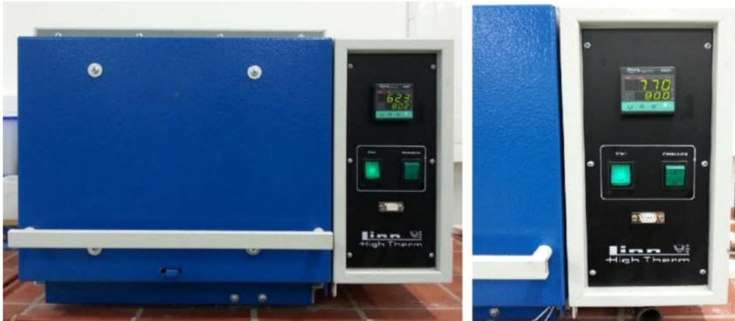
Figure 3.6: Four pour de chauffage des disques
