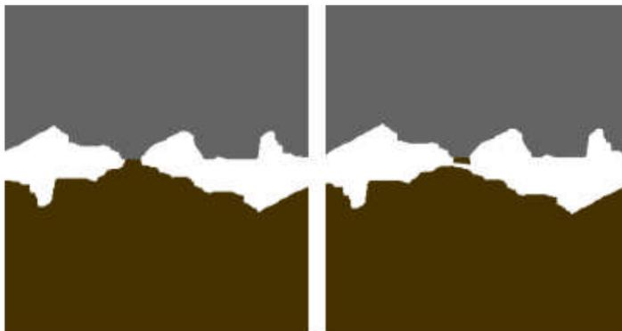
Figure 2.5 : Mécanisme d'usure adhésive [67].
