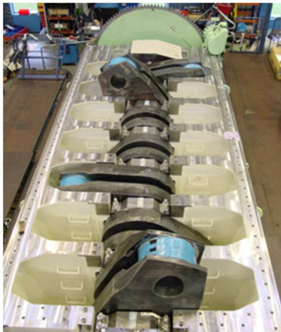
Figure 2.4. Logement du vilebrequin d'un moteur Diesel marin
