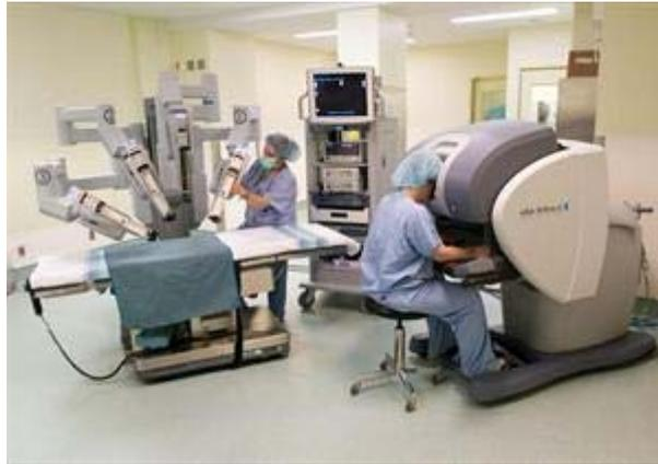
**Figure IV-6:** Le système Da Vinci : la console maître et les manipulateurs esclaves
