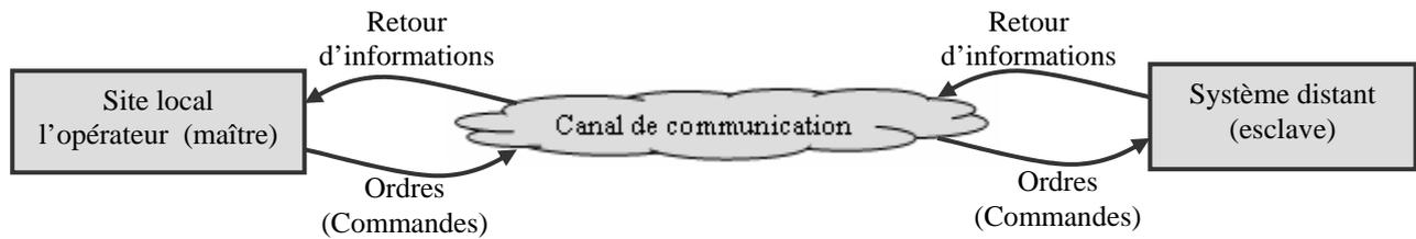
Figure IV-2 : Schéma d'une structure générale d'un système de téléopération
