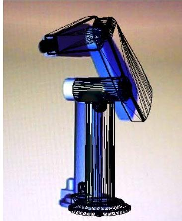
**Figure IV-26 :** Superposition de l'image virtuelle (en fil de fer) sur l'image réelle
