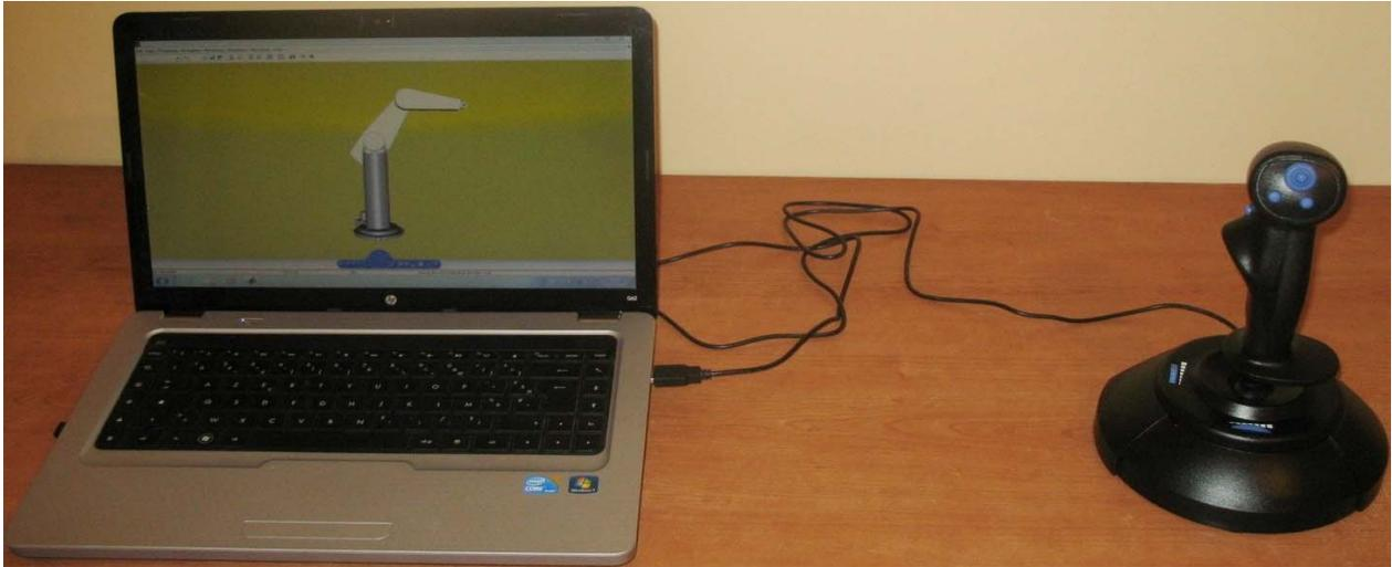
Figure IV-13 : Vue de couplage par USB entre le joystick et l'ordinateur
