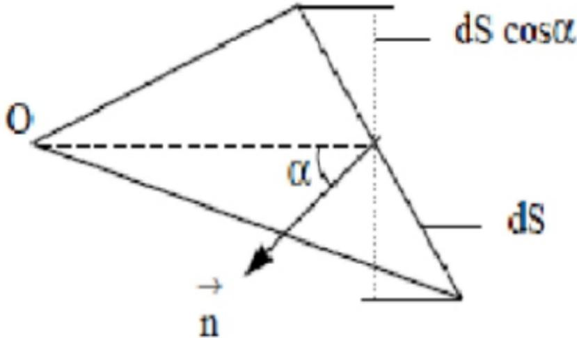
Figure: Schéma de l'angle solide
