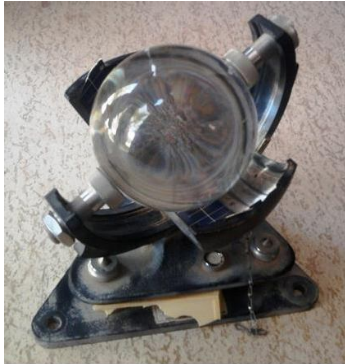
Fig. I-12 appareil de mesure de la durée d'insolation (héliographe).
