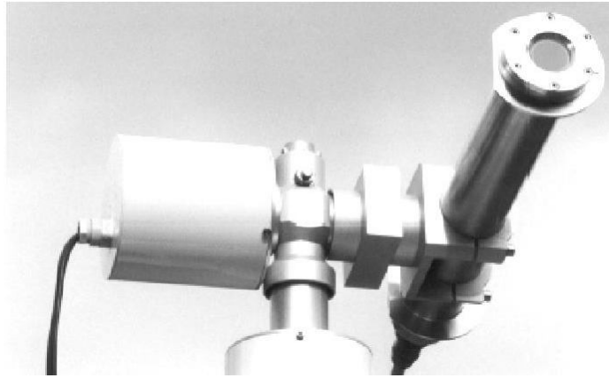
Fig. I-8 Appareil de mesure des rayons directs (pyrhéliomètre).
