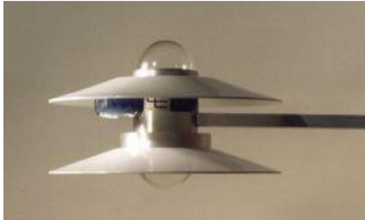
Fig. I-10 Appareil de mesure des rayons diffus (Albédo mètre).
