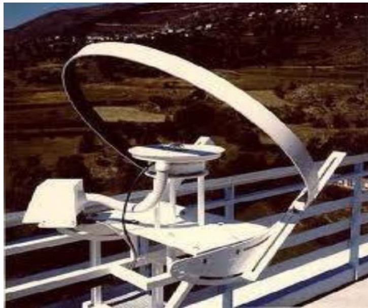
Fig. I-9 Appareil de mesure des rayons diffus (pyranomètre).
