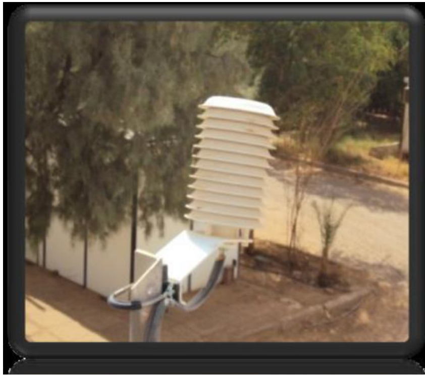
Fig. I-13 Appareil de mesure de la température (thermocouple).
