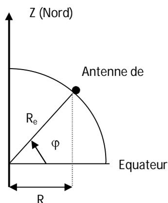
Figure 3.6. Conversion de la latitude dans le système ECI
