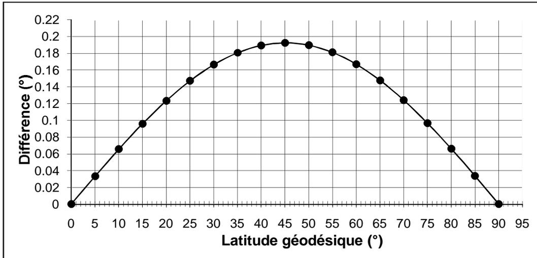
Figure 3.10. Différence entre la latitude géocentrique et la latitude géodésique
