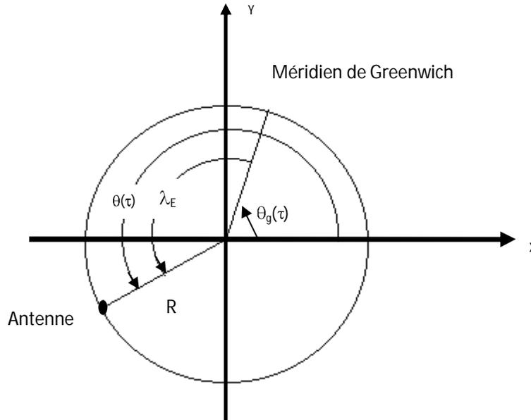
Figure 3.7. Conversion de la longitude dans le système ECI
