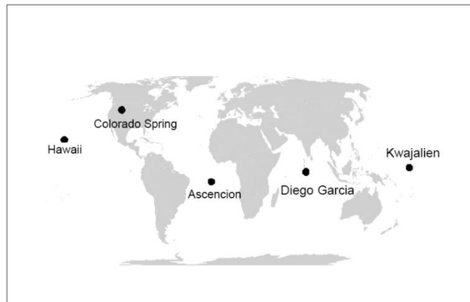
Figure 4.6. Les cinq stations de poursuite et de contrôle du système GPS
