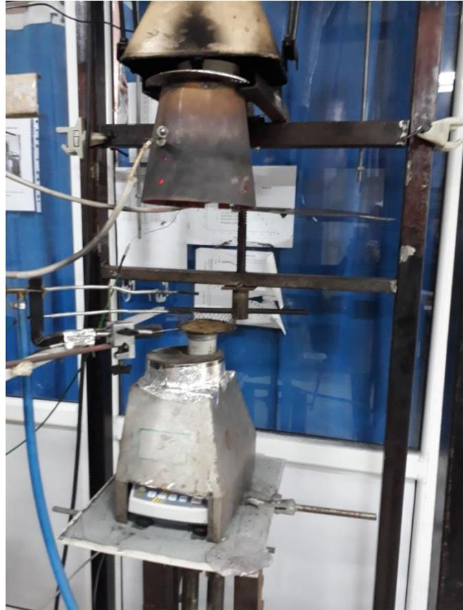
**Figure 1.15** Le cône calorimètre conçu au niveau du laboratoire LEPM
