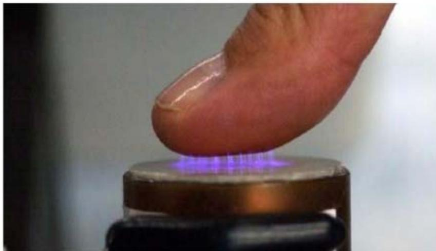
Figure I.15 : Image d'une décharge à barrières diélectriques typique dans l'air.
