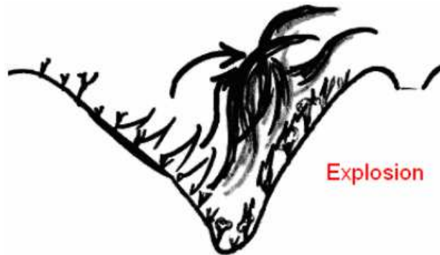
Figure I.4 : Explosion de la masse gazeuse sur le versant opposé
