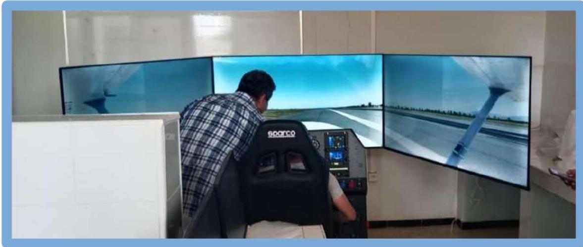
Le modèle de base d'un simulateur de vol et le système visuel est équipé d'un logiciel qui combine avec précision l'horizon artificiel, la manette des gaz et le palonnier.
